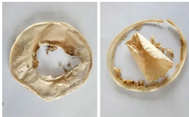
Màng polyurethane được tiêu hóa một phần ở bên trái và được tiêu hóa hoàn toàn ở bên phải trong phòng thí nghiệm bởi nấm ăn nhựa được phát hiện bởi nhóm của Mortimer
